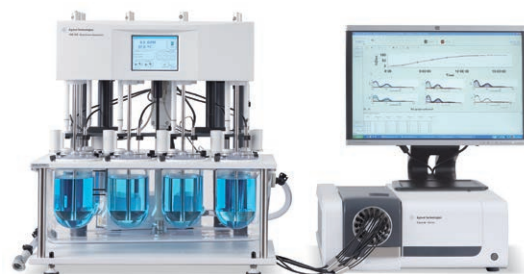
Agilent 708-DS 溶出度仪和 Cary 60 紫外-可见分光光度计，配备光纤多路复用器
