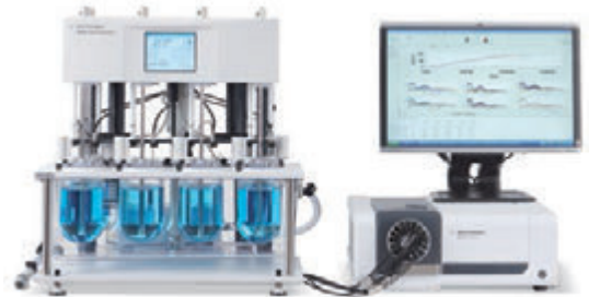
Apparato di dissoluzione Agilent 708-DS e spettrofotometro UV-Vis Cary 60 nella configurazione con un multiplexer a fibra ottica
