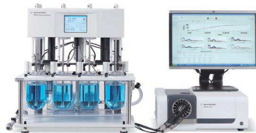
Appareil de dissolution Agilent 708-DS et spectrophotomètre UV-Vis Cary 60 montés avec un système multiplexe à fibre optique
