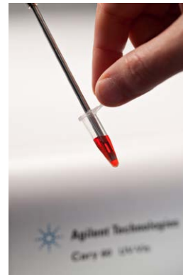
Sondes d'immersion à fibre optique
