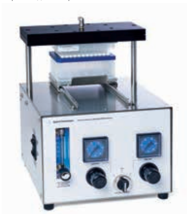
96-позиционное устройство для экстракции и фильтрации под давлением компании Agilent: вариант для 96-луночного планшета
