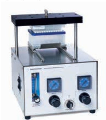
96-позиционное устройство для экстракции и фильтрации под давлением компании Agilent: вариант для 96-луночного планшета
