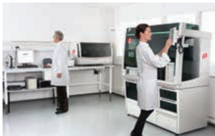
Dako Autostainer Link 48 e Dako Omnis per IHC (immunoistochimica) e colorazione IHC/ISH (ibridizzazione in situ) avanzata
