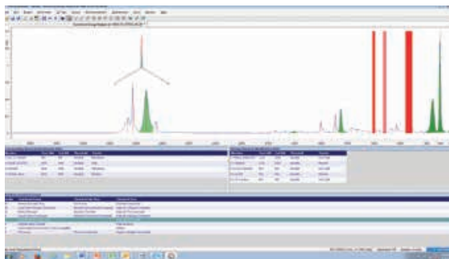
Nella schermata di interpretazione sopra riportata l'utente si chiede se lo spettro può contenere alogenuri. Le regioni di colore rosso indicano dove dovrebbero essere posizionate le bande; poiché non sono presenti bande, lo spettro non contiene alogenuri.
