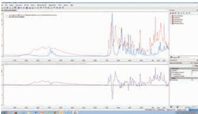
Sottrazione spettrale: i due spettri sono mostrati nella parte in alto; il risultato della sottrazione compare nella parte in basso.
