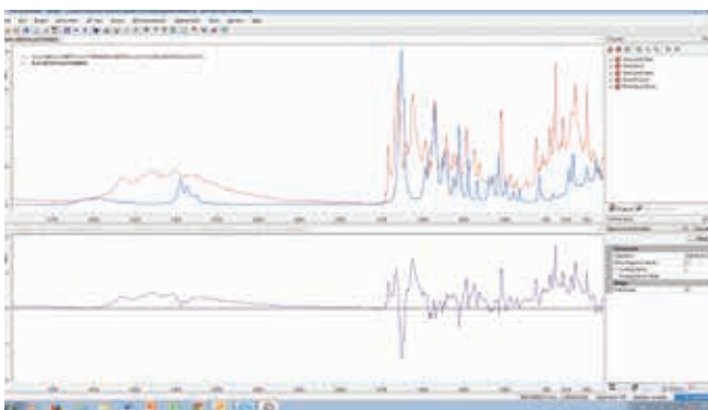
Spektrale Subtraktion: Die beiden Ausgangsspektren werden oben dargestellt, das Ergebnis der Subtraktion unten.
