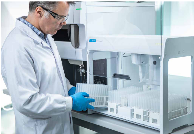
SPS 4 オートサンブラとオプションの一体型カバー。サンプルへのアクセスが容易できるようにフロントカバーが開いた状態で固定されています。
