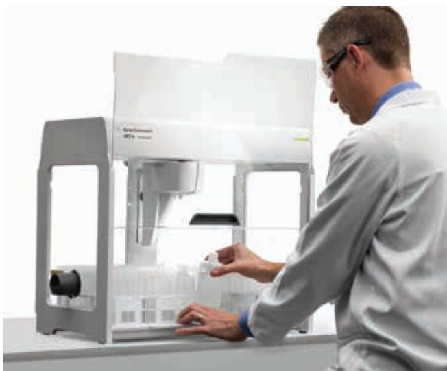
Автосамплер SPS 4 показан в комплекте с поставляемыми по требованию интегрированными в конструкцию шторками для изоляции от окружающей среды. Передняя шторка показана зафиксированной в открытом положении, обеспечивающем удобный доступ к пробам.
