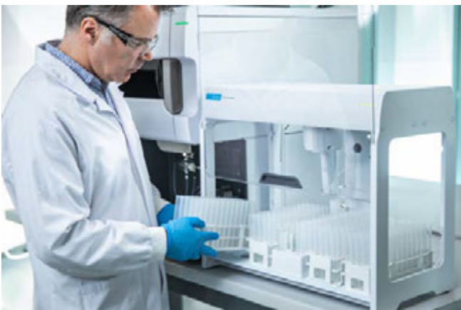
Amostrador automático SPS 4 mostrado com o opcional gabinete integrado para proteção contra interferências ambientais. Tampa frontal mostrada fixada na posição aberta para fácil acesso às amostras.
