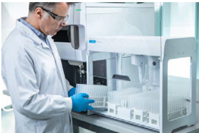
Passeur automatique d'échantillons SPS 4 avec l'option capot intégré. Le panneau frontal est montré en position ouverte fixe pour un accès facile aux échantillons.
