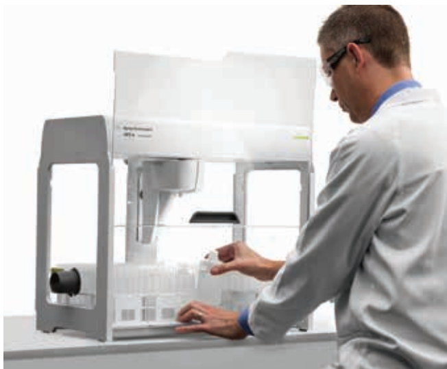
Muestreador automático SPS 4 con la opción del recinto integrado de protección del entorno. La cubierta frontal se encuentra abierta para permitir un fácil acceso a las muestras.
