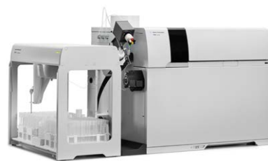
具有可选快速 TRA 功能的 7800 ICP-MS 为单纳米颗粒分析提供了经济有效的解决方案
