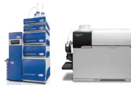
ICP-MS quadrupolo Agilent 7900 integrado ao sistema PostNova AF2000MT AF4 FFF.
