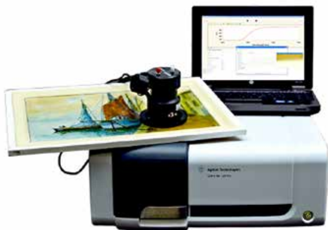
Na foto acima, o UV-Vis Cary 60, com uma sonda de fibra óptica inovadora para a análise remota de objetos
