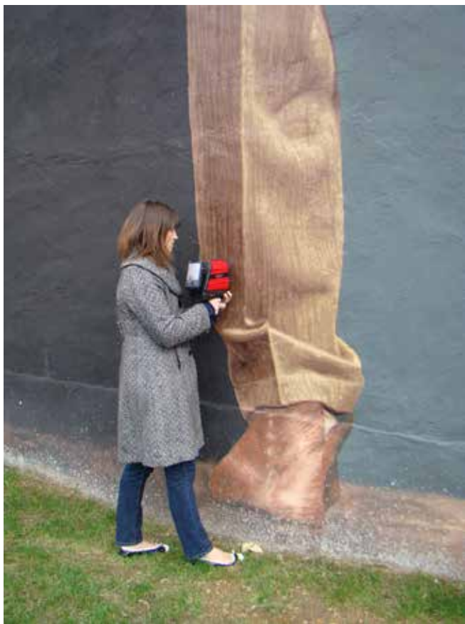
Na foto acima, o FTIR 4100 ExoScan, que mede amostras delicadas de forma não destrutiva em todos os tipos de locais.
