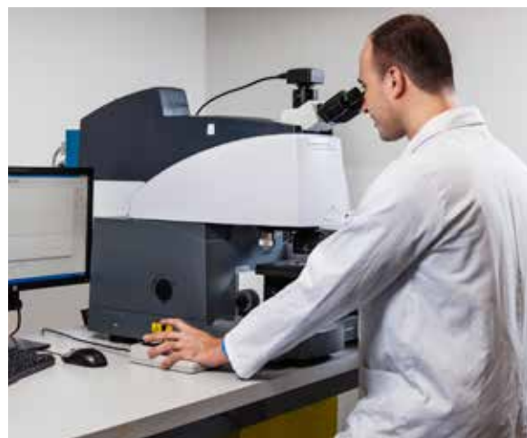
Na foto acima, o Microscópio e sistema de imagens FTIR Cary 620 podem medir amostras de alto valor em questão de minutos.
