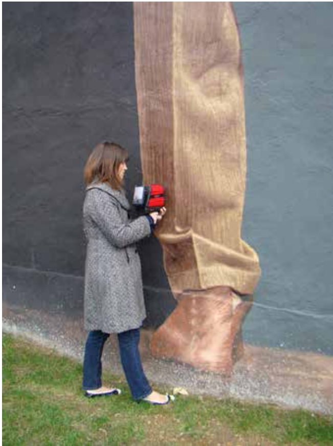
Qui sopra è rappresentato il sistema FTIR 4100 ExoScan, che misura in modo non distruttivo campioni delicati situati in qualsiasi luogo.
