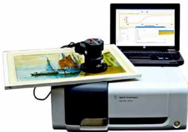
L'illustration ci-dessus montre le système Cary 60 UV-Vis avec son accessoire de mesure déportée par fibre optique pour l'analyse d'objets à distance
