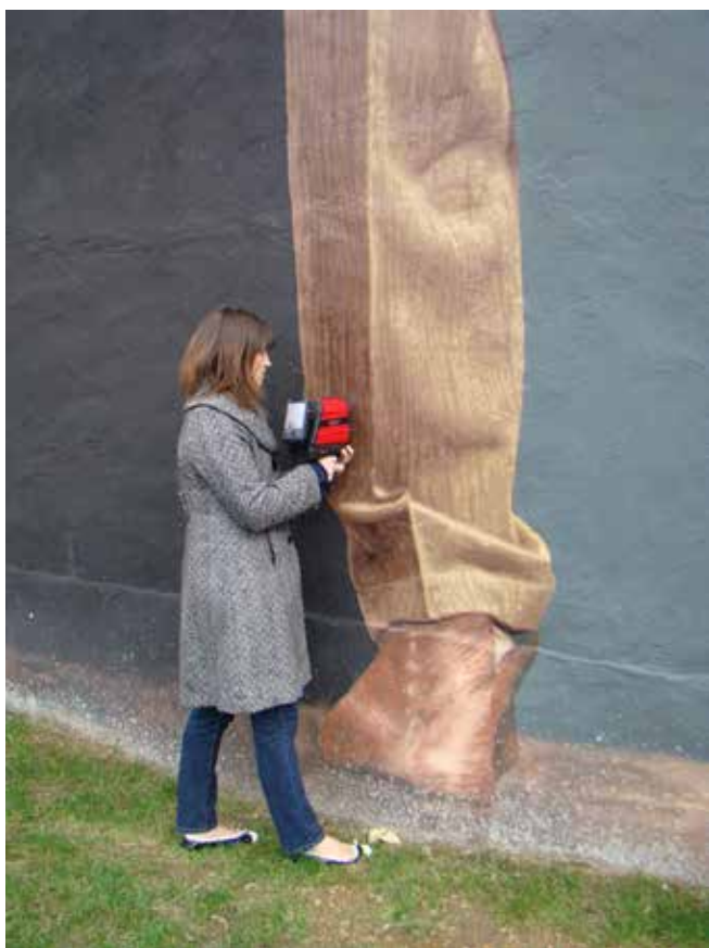
Dans l'illustration ci-dessus, le système FTIR 4100 ExoScan mesure des échantillons délicats de manière non destructive dans des zones très différentes.
