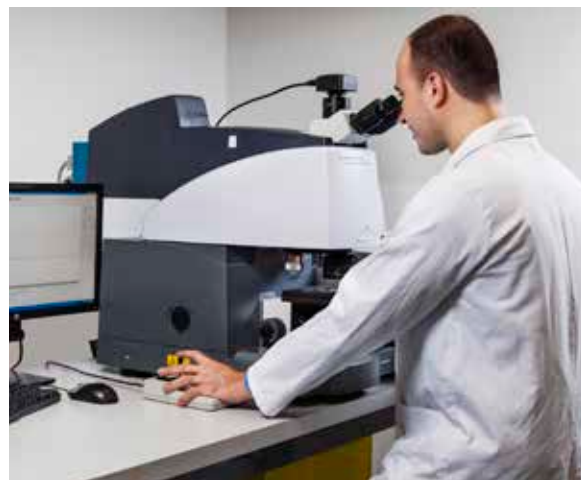
L'illustration ci-dessus montre que le système de microscopie et d'imagerie chimique FTIR Cary 620 peut mesurer des échantillons délicats de pièces extrêmement précieuses en quelques minutes.
