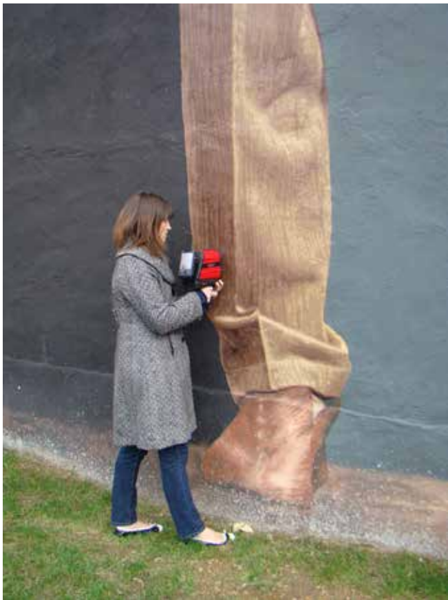
En la imagen superior, el sistema FTIR 4100 ExoScan mide muestras delicadas de forma no destructiva en todo tipo de ubicaciones.
