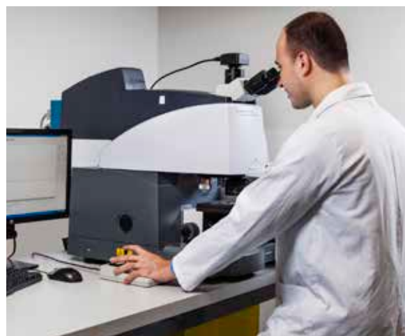
En la imagen superior, el sistema de imágenes y microscopio FTIR Cary 620 puede medir muestras delicadas y de alto valor en cuestión de minutos.
