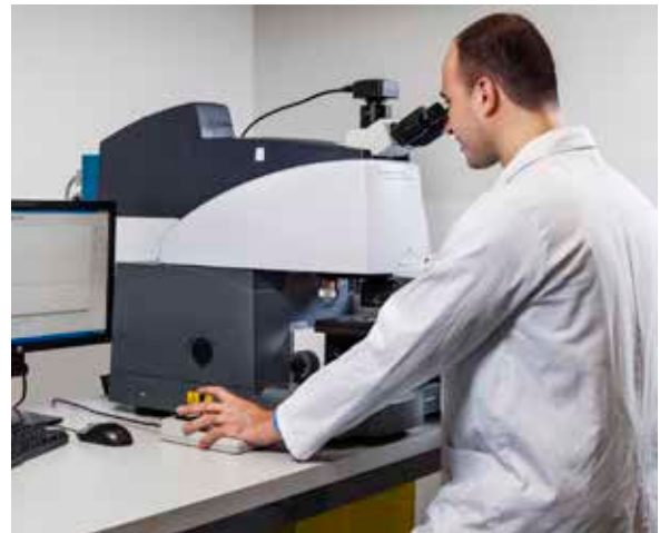
Das oben abgebildete Cary 620 FTIR-Mikroskop und System für chemisches Imaging kann empfindliche Proben innerhalb von Minuten messen.
