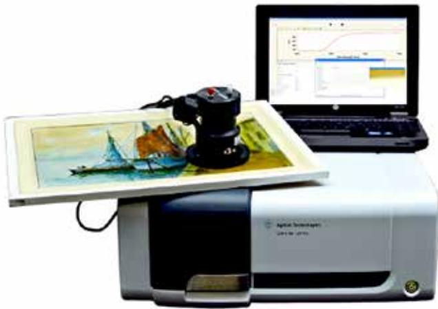
Oben abgebildet: das Cary 60 UV/Vis-Spektrometer mit innovativer UV-Sonde für die Analyse von Objekten vor Ort
