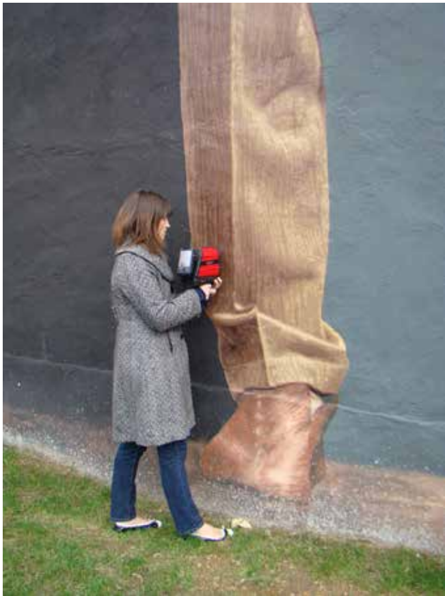
Das oben abgebildete 4100 ExoScan FTIR misst empfindliche Proben zerstörungsfrei an jedem Einsatzort.
