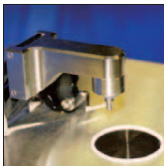
Agilent 4500a FT-IR のダイヤモンド ATR インターフェースにより、固体、ペースト、ゲルを問わず、確実な測定が可能となります。
