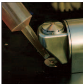
Agilent 4500t FT-IR の TumbIR インターフェースにより、液体中の微量成分が容易に定量できます。
