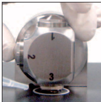
Agilent 4500 DialPath FT-IR により、毎回再現性のある光路長での測定結果が得られます。
