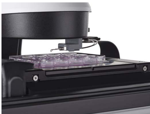
圖 4. Agilent BioTek Lionheart FX 自動化活細胞影像系統分注模組的齊頭針
