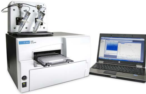
그림 3. Agilent BioTek 이중 시약 주입기 모듈이 장착된 Agilent BioTek Synergy HTX 멀티모드 리더.
