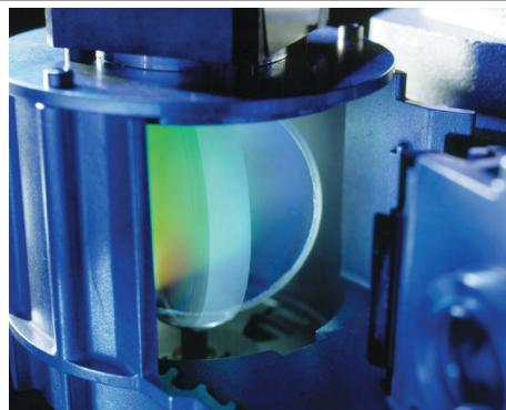
Les réseaux holographiques à rotation rapide permettent le multisignal et l'acquisition des données spectrales
