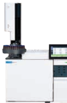
Автосамплер Agilent 7650A на ГХ Agilent 8890
