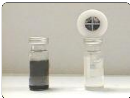
Рисунок 1. Раствор полиэтилена, содержавший углеродную сажу, успешно отфильтрованный на фильтрующем элементе из стекловолокна с пористостью 1 мкм.
