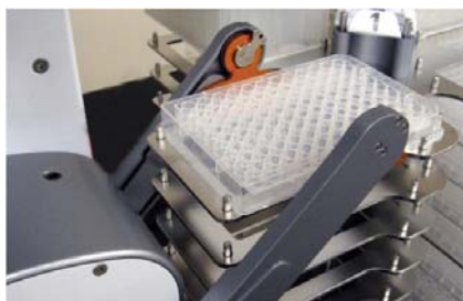
图 8: BenchCel 机械臂从 Agilent Labware MiniHub 上取下微孔板
