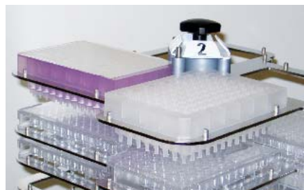
图 3：支架中的支承块适用于放置过滤板
