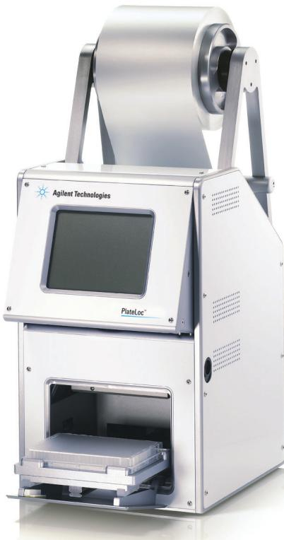
由于配备了扩展行程板架、RS-232 串口和 ActiveX 控件，PlateLoc 封膜机与每一个安捷伦自动化解决方案（Agilent Automation Solution）一样，对于机器人系统的整合效果都非常理想。为了将补充耗材时的系统停机时间缩到最短，PlateLoc 封膜机具有容易进入的、从顶部加载的密封膜卷支架，并且每一新卷密封膜都包括一张方便使用的密封膜加载卡，这让安装新卷密封膜变得简单和安全。针对不同应用，我们提供多种铝质和透明的封膜材料。
