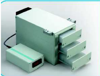
ペリチェ冷却システムスタック(4~40°C) 6 シャローウェルプレート(96 穴、384 穴)または 6 ディープウェルプレート(96 穴、384 穴)または 6 バイアルトレイ(2mLバイアル)
