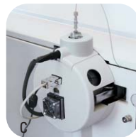
C Utilice la fuente APPI PhotoMate para ionizar muestras cuya respuesta es deficiente o nula con las fuentes APCI y ESI.
