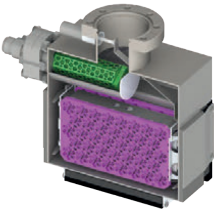
Coupe montrant l'ensemble pompe principale de la pompe ionique CombiNEG 40-400 (en version StarCell), après montage de la pompe à getter D400-2.
