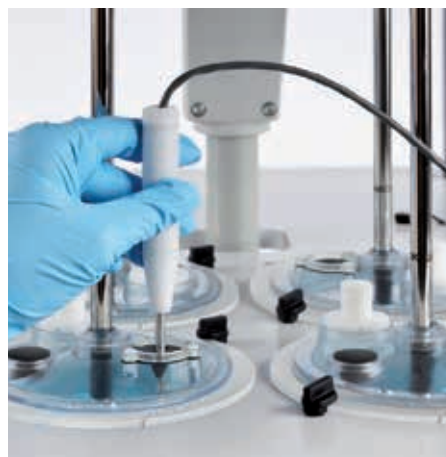
Medida manual de la temperatura con la sonda de temperatura manual integrada del 708-DS.
