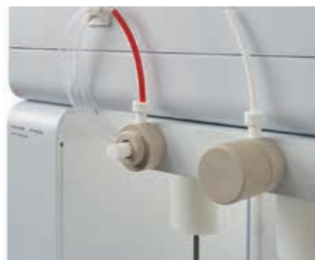
Carcasa de filtro en línea (PEEK) (ref. K1200-00855), se muestra en el soporte para montaje opcional.
