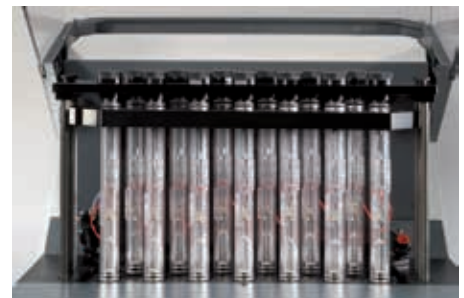
Vista interna de los soportes para celdas
