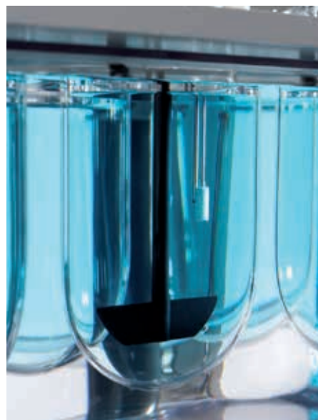
Cánulas de muestreo no residentes en un vaso TruAlign del instrumento 708-DS.
