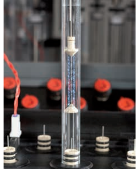
Celda de muestra para instrumentos 400-DS con soporte de prótesis vasculares.
