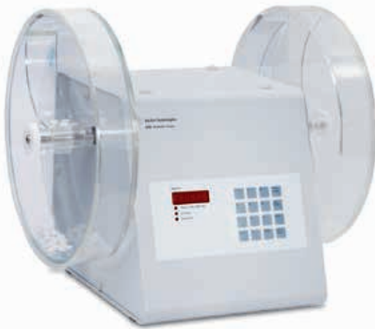
Analizador de friabilidad Agilent 250 con dos tambores de doble cámara.
