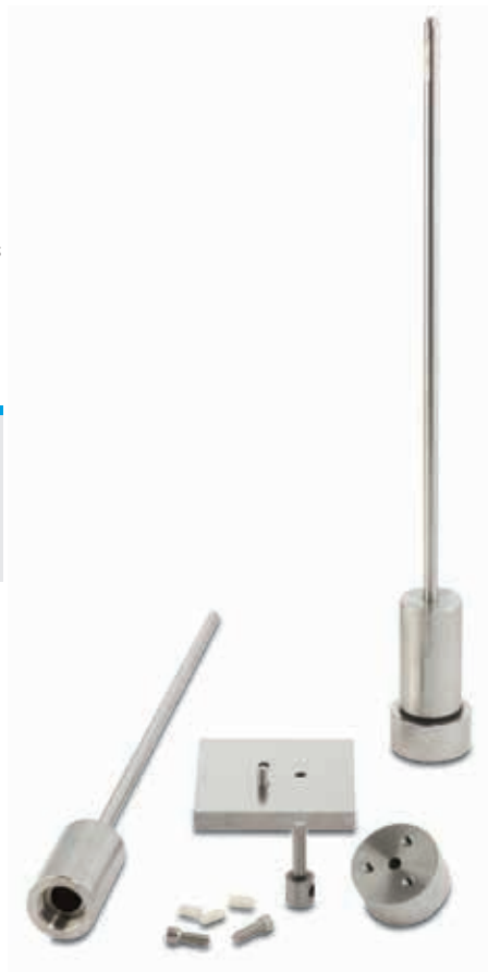
Instrumento de disolución para pruebas de velocidad intrínseca (ref. 12-4101) y accesorios.
