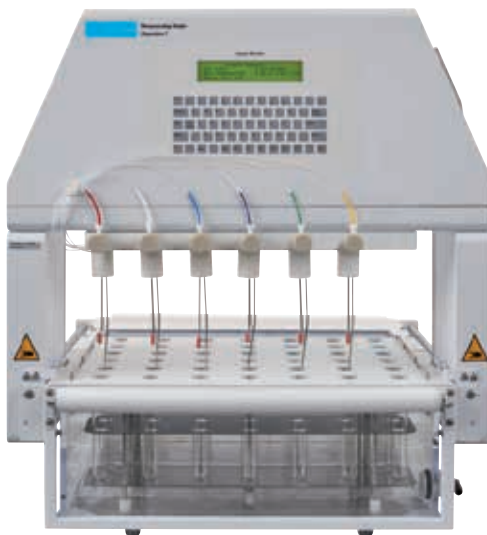
Soporte de movimiento alternativo para instrumentos USP Aparato 7 de 50 ml que se muestra con una configuración automatizada de 6 x 7.
