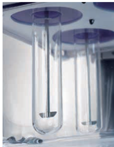
El kit de conversión EaseAlign 200 ml (ref. 12-0318) incluye un recipiente adaptador, una minipaleta y un vaso de 200 ml para los análisis de disolución de volúmenes pequeños.
