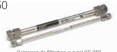
Colonnes de filtration sur gel GF-250
