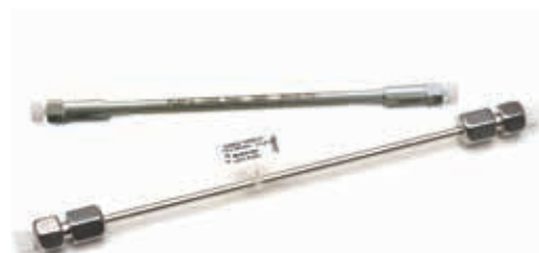
Sterisch geschützte gebundene Phase von 300StableBond
