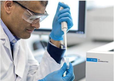
UV-Vis 系统的光束高度将决定比色皿的最小填充体积
