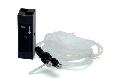
荧光流通池，40 \mu L，10 mm 光程，提供带有 M6 螺纹接头的入口和出口 PTFE 管线（外径 1.6 mm），6610023700
