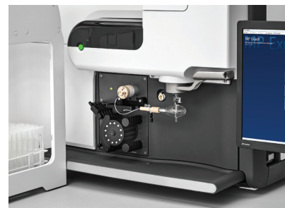
安装在 4210 MP-AES 上的高级四通切换阀 (AVS 4) 系统
