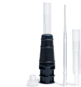
完全可拆卸式易安装炬管, 带内径 2.4 mm 石英中心管, 用于高 TDS 样品, G8020-68004
