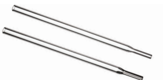
上: インジェクタ、石英製、内径 2.0 mm、8003-0374
