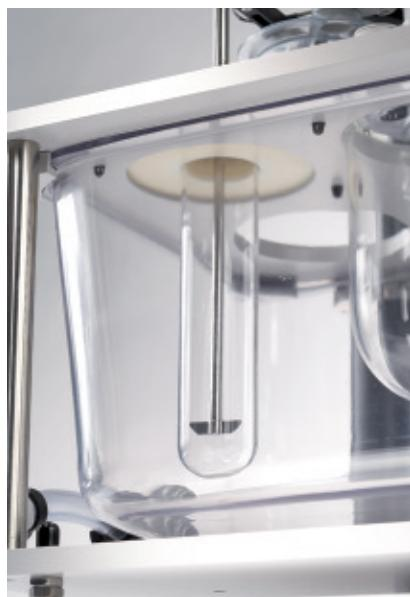
708-DS 转换工具包，带微型桨的 200 mL 溶出杯
