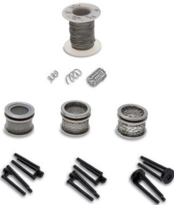
胶囊沉降金属线（第一行）、两种类型的沉降线圈和日本沉降线圈（第二行）、筛网沉降篮（第三行）和 3 爪式沉降配重（第四行）
