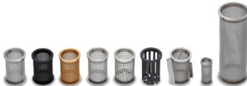
(由左至右) 40 目转篮、PTFE 涂层转篮、镀金转篮、20 目转篮、10 目转篮、开槽篮、3 缸篮、微型转篮和大丸药篮
