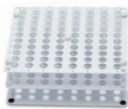
取样盘，包括带隔垫-瓶盖的 HPLC 样品瓶（上）和玻璃试管（下）
