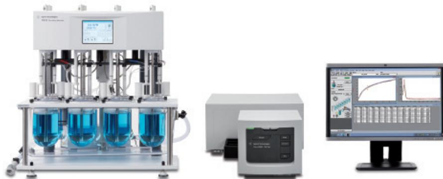
配置 Cary 8454 紫外-可见分光光度计和 UV 化学工作站软件的 708-DS 溶出度仪
