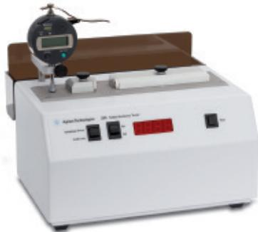
Agilent 200 型片剂硬度测试仪
