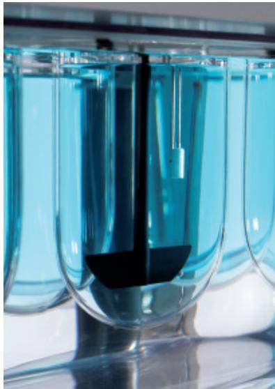
708-DS 中 TruAlign 溶出杯内的非驻留取样插管
