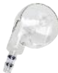
Twister-Zerstäuberkeramer aus Glas mit doppeltem Durchgang, 7910043700
