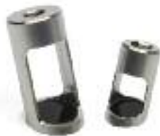
Kit mit faseroptischen Fluoreszenzspitzen für flüssige Proben, 9910104500
