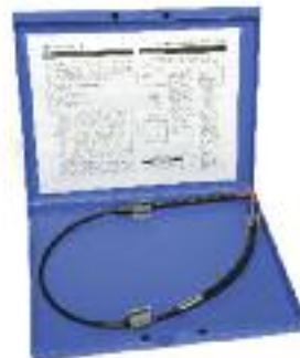
Faseroptische Tauchsonde, feste Schichtdicke 10 mm, 7910036400
