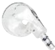
Zyklon-Zerstäuberkeramer mit einfachem Durchgang, 2010081700
