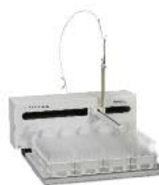
ASX-520 Automatischer Probengeber
