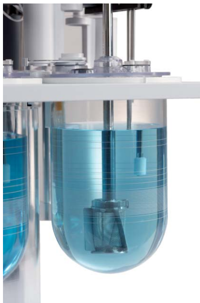
用于 DVH 溶出杯内预热的定制篮
