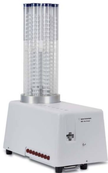
安捷伦 808 滤头更换装置与 25 mm ROBY 自动化过滤器一起使用
