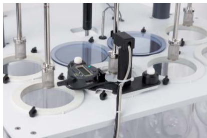
708-DS 的物理参数验证如上所述比较简单，用 QAll C 机械认证工作站测量 RPM 和转轴的晃动
