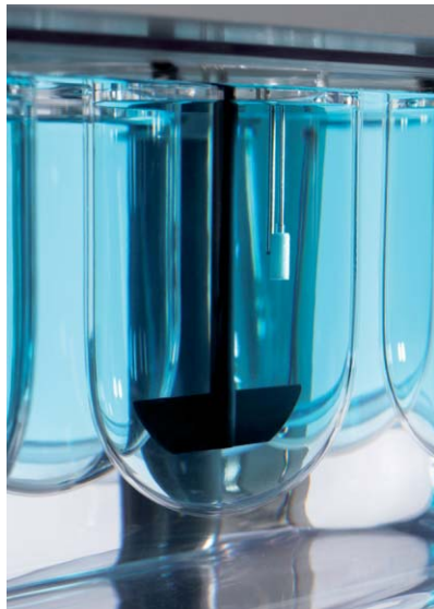
708-DS 中 TruAlign 溶出杯内无残留取样插管
