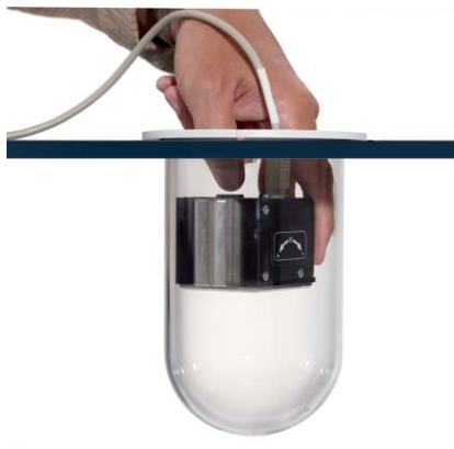
用 QAI C 进行溶出杯的垂直度测量
