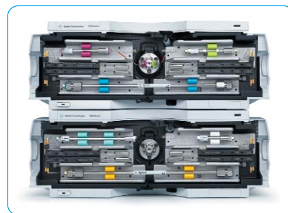
Figura 2: Il compartimento colonne termostato consente di valutare colonne di diverse dimensioni a varie temperature.
