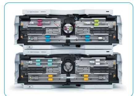
Abbildung 2 Mit Säulenthmostaten lassen sich Säulen verschiedener Größen bei verschiedenen Temperaturen testen.
