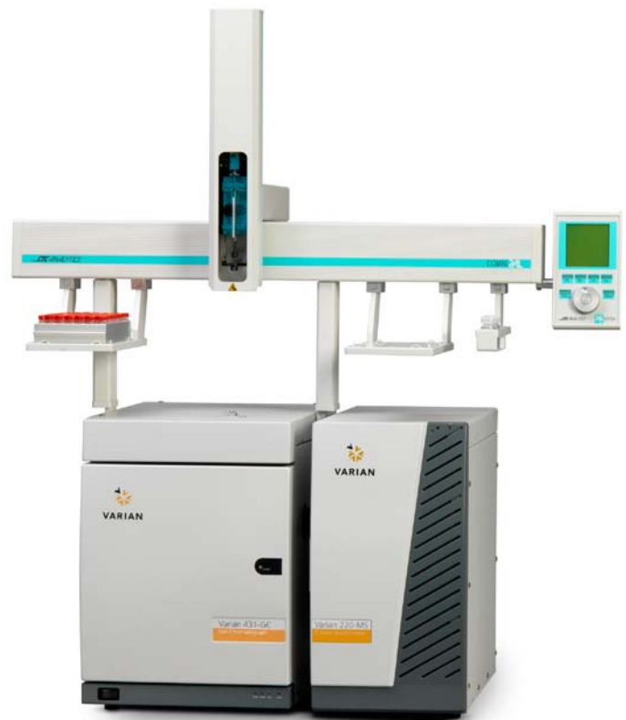
Das Varian 210-MS mit dem Varian 431-GC macht die GC/MS für Routine-Anwender und Laboratorien mit begrenzten Räumlichkeiten bzw. niedrigen Budgets zugänglich.
