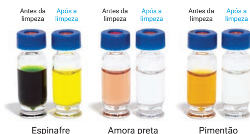
Figura 1. Os produtos Carbon S demonstram um melhor equilíbrio entre a recuperação do analito e a eficiência de remoção do pigmento da matriz. A) Remoção eficiente de pigmentos para frutas e vegetais frescos. 1 B) Recuperação melhorada de pesticidas planares. 2
