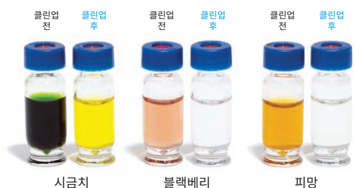
그림 1. Carbon S 제품은 분석물질 회수와 매트릭스 색소 제거 효율 간의 더 나은 균형을 보여줍니다.
