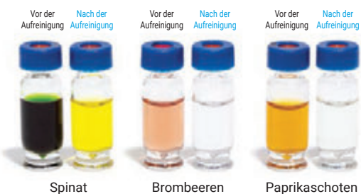
Abbildung 1: Carbon S Produkte sorgen nachweislich für eine bessere Ausgewogenheit zwischen Analytwiederfindung und der Effizienz der Pigmententfernung aus der Matrix. A) Effiziente Pigmententfernung bei frischem Obst und Gemüse. B) Bessere Wiederfindung von planaren Pestiziden. 1,2
