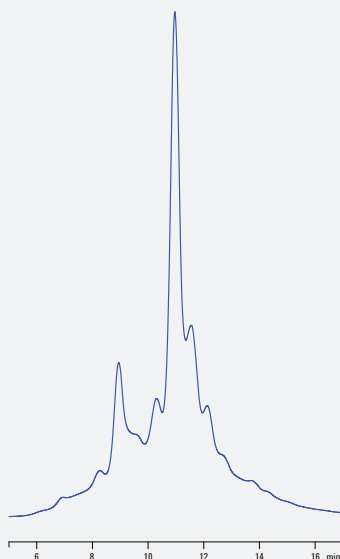
6.5~7.5 の pH グラジエント (0~20 分)、50 mM、Agilent Bio MAb 5 \mu m、4.6 x 50 mm を用いた IgG モノクローナル抗体の分析。
