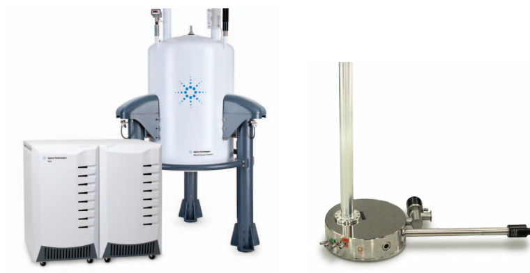
図 9. 代謝物の構造解析に最適な NMR (600 MHz NMR システム (左) と 3 mm MicroSample コールドプローブ (右))。アクティブシールド技術を備えたナローボア 600 MHz 磁石は、従来の 400 MHz 磁石と同じスペースに収まるため、ラボのスペース上の制約にも対応できます。
