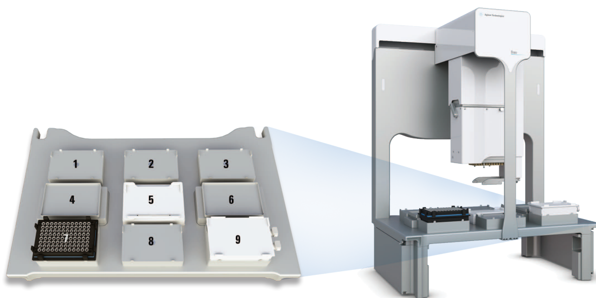
図 15. Agilent Bravo 自動液体処理プラットフォームおよび CYP450 アッセイ用のデッキレイアウトと、Orbital Shaking Station (ロケーション 8)。プロトコル開始前に、5 枚のマイクロプレートのスタック 1 つ (ロケーション 7) と、リザーバ 3 つ (ロケーション 1~3)、チップボックス 3 つ (ロケーション 4~6) をデッキ上に手動で配置しています (アジレント文献 5990-3550EN 参照)。
