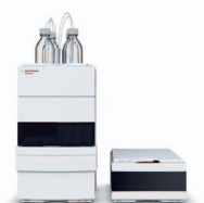
1220 Infinity グラジエント LC と 1260 Infinity フラクションコレクタ
