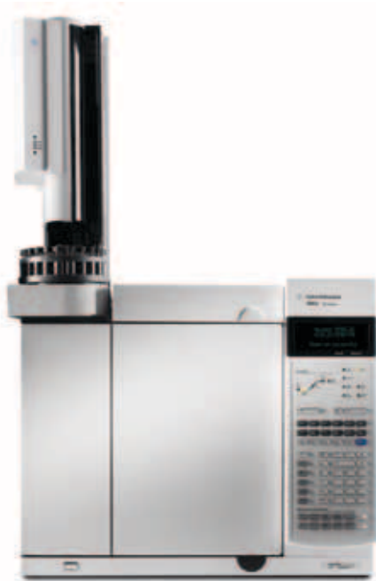
Agilent 7890A ガスクロマトグラフは、優れた分離機能と生産性向上のための機能を両立させた業界を代表する GC プラットフォームです。
