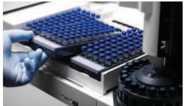
7693A オートサンブラは高速注入性能に加え、希釈・内標添加・溶媒抽出・誘導体化などの各種前処理の自動化機能を装備しています。
