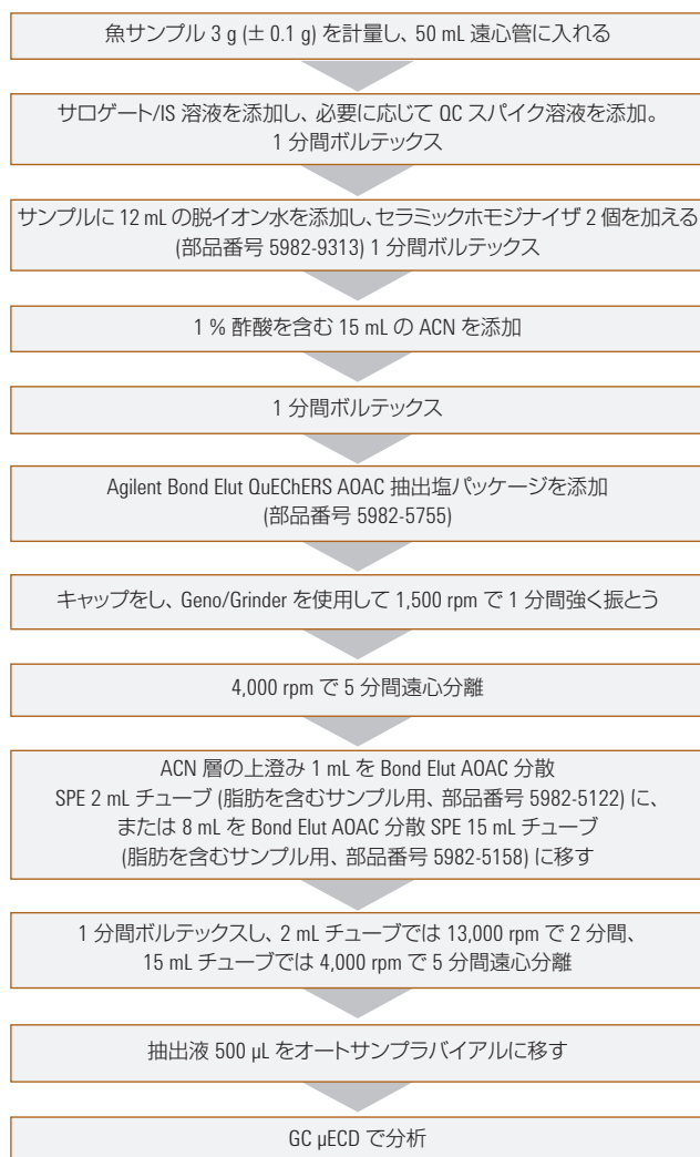
図 1. 魚用の修正版 Agilent Bond Elut QuEChERS AOAC 抽出手順
