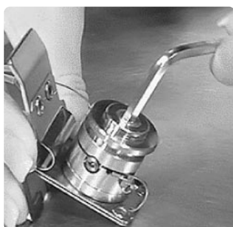
第三步：取出流通池螺钉，并取出垫圈。
